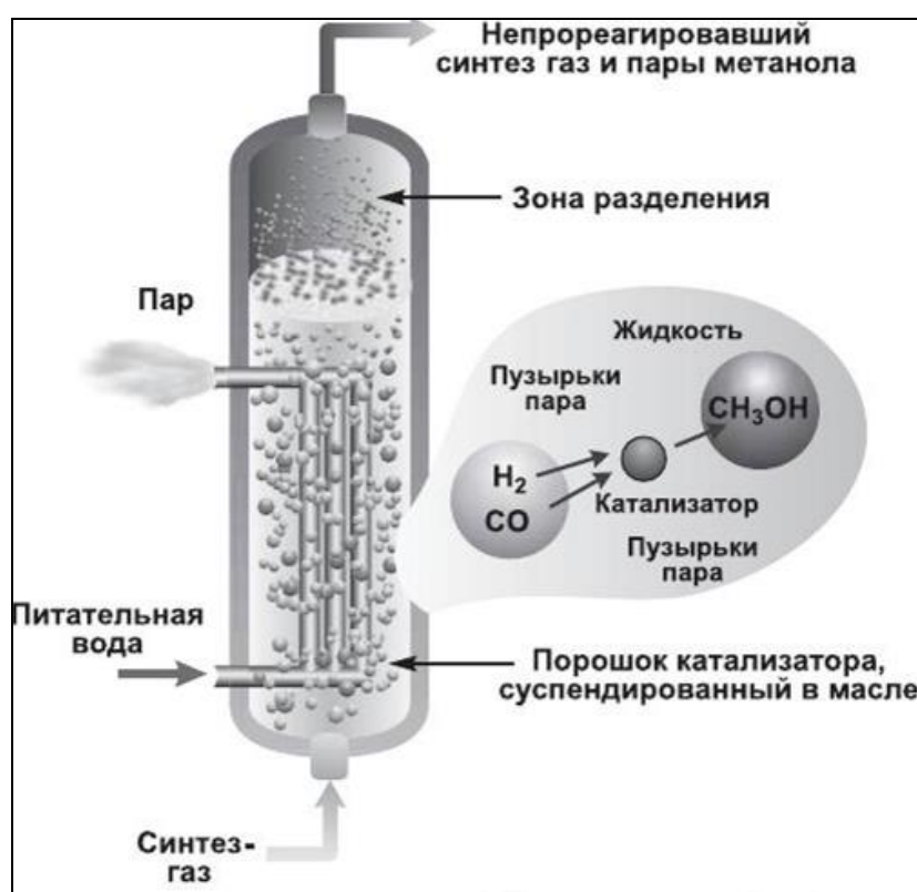
Рис 5. Структурная схема производства метанола
